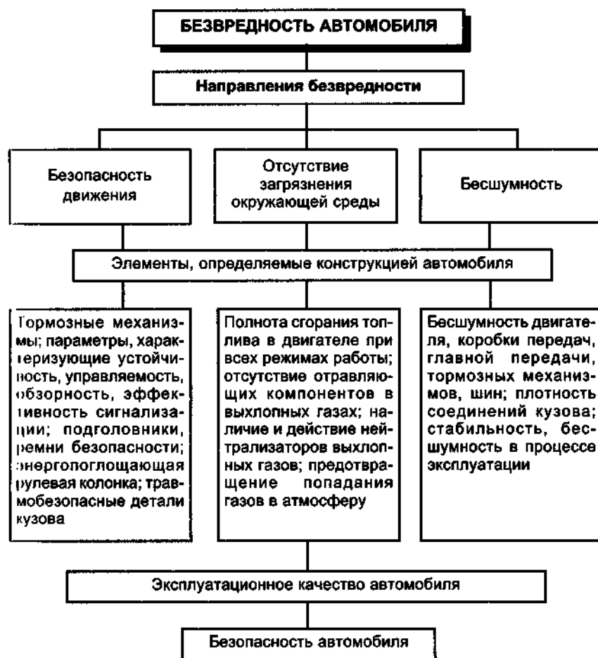
Рис. 4.1. Зависимость безвредности автомобиля от его конструкции и эксплуатации (В.В. Амбарцумян, «Экология и жизнь» № 2, 1999 г.)
