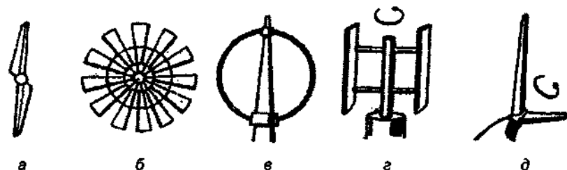
Рис. 3.11. Рабочие колеса перспективных ветроэнергетических установок: а — быстроходное двухлопастное; б — многолопастное; в — ветроколесо Дарье с вертикальной осью; г — ветродвижитель; д — ветроколесо с наклонной осью
